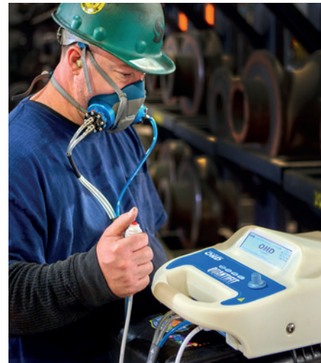
Figur 3 – Kontrollerat negativt tryck – OHD® Quantifit® CNP med REDON-metoden används för att utföra ett kvantitativt passformstest (QNFT) på en testperson som bär en halvmask. Bild: Med tillstånd från OHD®
