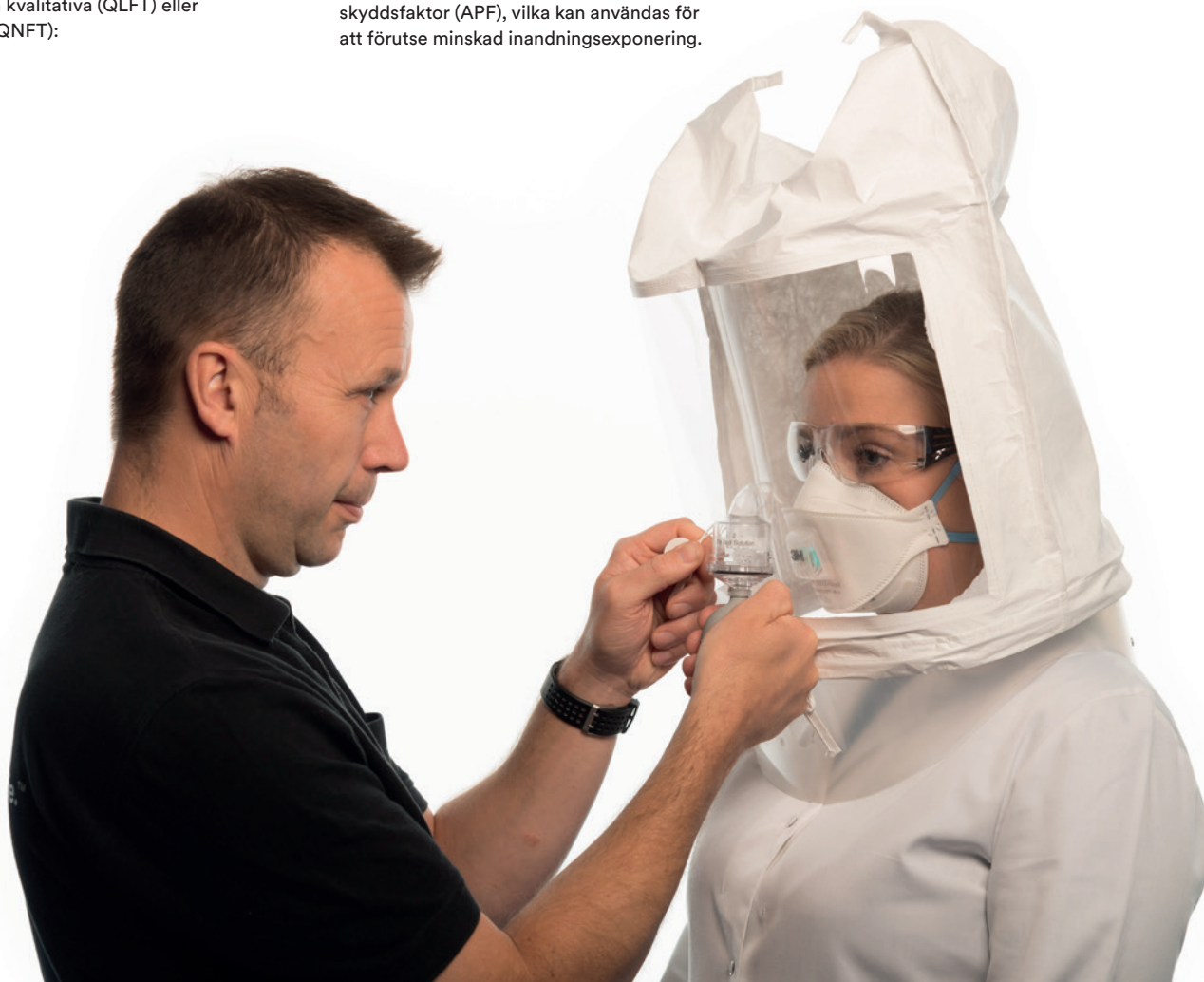
Figur 1 – 3M™ Kvalitativt Testsystem och Bitrex®Tillpassningskit används för att utföra ett kvalitativt passformtest (QLFT) på en testperson som bär en filtrerande halvmask
