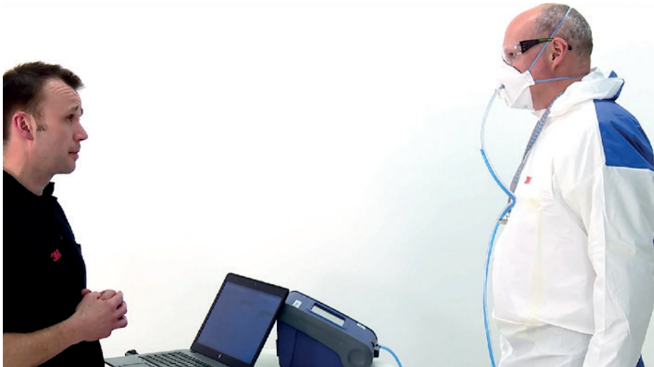
Figur 2 – Luftpartikelmätning – TSI® PortaCount® Testmetod för Andningsskydd Modell 8038 används för att utföra ett kvantitativt passformstest (QNFT) på en testperson som bär en filtrerande halvmask
